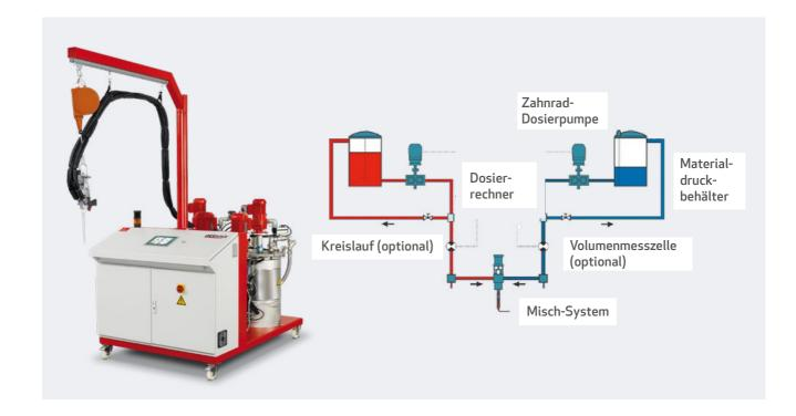
Die eldomix 600 ist eine spülmittelfreie Zahnrad-Dosier- und Mischanlage. Sie wird eingesetzt, um nieder- bis mittelviskose Mehrkomponenten-Medien auf Basis von z.B. Polyurethan, Silikon oder Epoxid zu verarbeiten. Spezielle Konfigurationen zur Verarbeitung hochviskoser Medien sind ebenfalls möglich.
