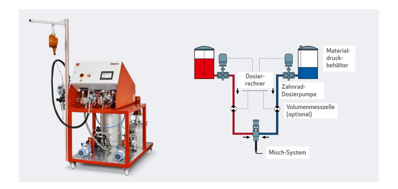
Die eldomix 100 ist eine spülmittelfreie, kompakt aufgebaute Zahnrad-Dosieranlage. Sie wird eingesetzt, um nieder- bis mittelviskose Mehrkomponenten-Medien auf Basis von z. B. Epoxid, Polyurethan oder Silikon in einem Mischungs-
